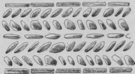
FIG. 11. — Parement d'un mur construit en cailloux, dit Arête de poisson .
