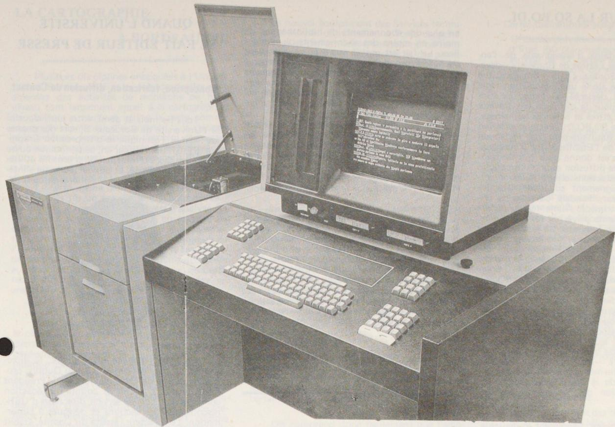
Ce matériel de photocomposition rassemble en une seule machine à clavier intégré les plus grandes capacités de traitement de l'information, de correction, de mémorisation et de composition.
